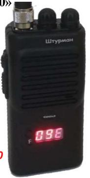
2.5. Следите, чтобы при работе положение антенны не сильно отклонялось от вертикального.
